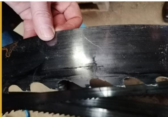
Exemple de fissure sur une lame : à ne surtout plus utiliser !
