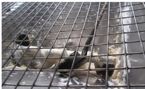
Trémie avec vis sans fin pour préparer le candi
