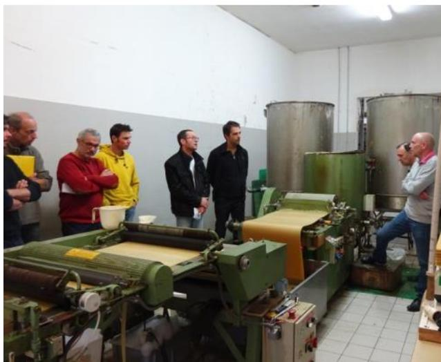
Matériel pour la fonte, le laminage et le gaufrage de la cire
